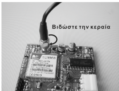
Σχήμα 4 : Τοποθέτηση κεραίας στην πλακέτα BS-464. Σημείωση!! Συνιστάται η κεραία να τοποθετείται εκτός του πίνακα, για την μέγιστη δυνατή απόδοσή της. Το καλώδιο της κεραίας μπορεί να ακολουθήσει την όδευση των υπόλοιπων συνδεδεμένων καλωδίων του πίνακα μέσω των αντίστοιχων οπών της βάσης.
