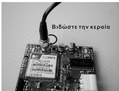
Σχήμα 4 : Τοποθέτηση κεραίας στην πλακέτα BS-464. Σημείωση!! Συνιστάται η κεραία να τοποθετείται εκτός του πίνακα, για τη μέγιστη δυνατή απόδοσή της. Το καλώδιο της κεραίας μπορεί να ακολουθήσει την όδευση των υπόλοιπων συνδεδεμένων καλωδίων του πίνακα μέσω των αντίστοιχων οπών της βάσης.
