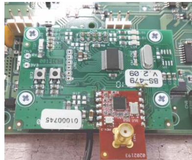
Σχήμα 5 : Στερέωση της πλακέτας BS-479
