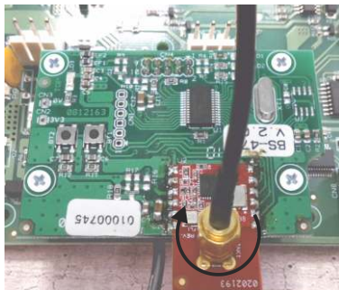
Σχήμα 6 : Σύνδεση κεραίας στην πλακέτα
