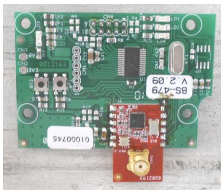
Σχήμα 1 : Κάτοψη πλακέτας BS-479
