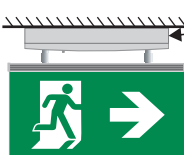
Τοποθέτηση στην οροφή
