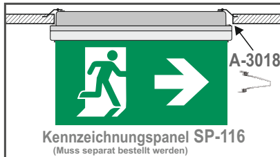
Montage in abgehängter Decke mit Befestigungsfedern A-3018 und Kennzeichnungspanel SP-116
