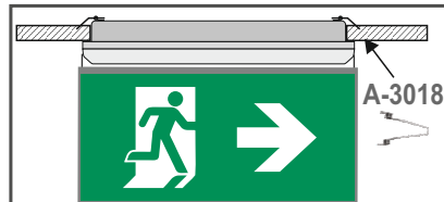
Χωνευτή τοποθέτηση σε ψευδοροφή με βάση A-3018 και με πινακίδα σήμανσης SP-116
