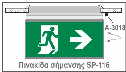
Χωνευτή τοποθέτηση σε ψευδοροφή με ελατήρια A-3018 και με πινακίδα σήμανσης SP-116
