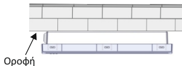
Τοποθέτηση σε οροφή
